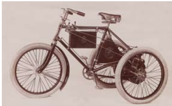
Le tricycle de 1901 à moteur de Dion-Bouton. Le modèle créé l'année suivante fut doté d'un moteur Peugeot Frères. Cliché Barbier YC 240
